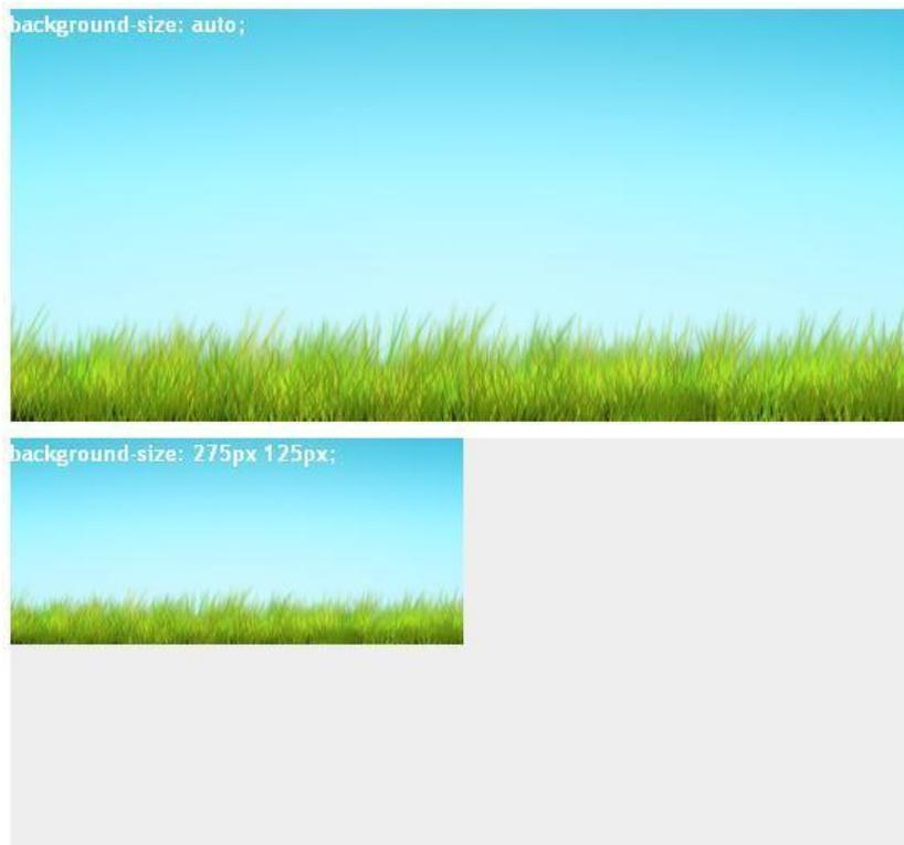
La primera imagen contiene un fondo que abarca todo el contenedor, mientras q la segunda especifica el tamaño del fondo sobre el contenedor
